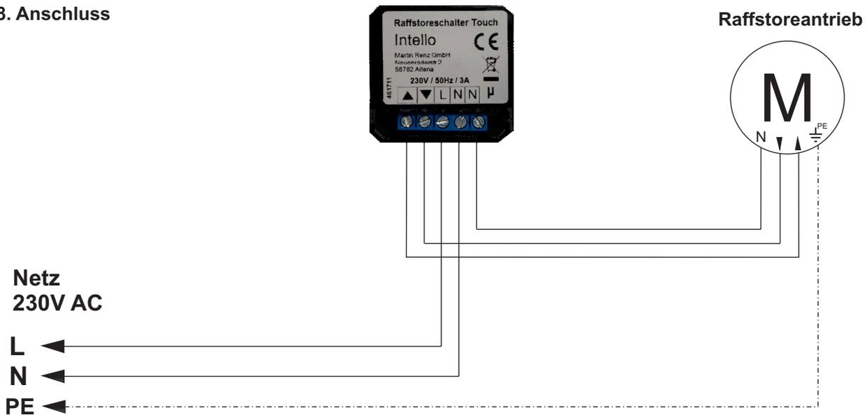
**ACHTUNG:** Bei dem ersten unter Spannung setzen des Produktes wird die kapazitive Touchfläche automatisch eingelernt. Es ist wichtig, daß das Gerät beim ersten Einschalten richtig fest verbaut ist, und noch nicht betätigt wird, bzw. von den Fingern / Hand berührt wird. Nur so ist die richtige Funktion des Raffstoreschalters in der Zukunft gewährleistet.
